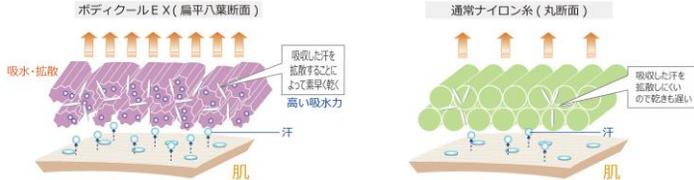
毛細管現象により、丸断面の通常ナイロン糸よりも更に高い吸水性・拡散性がある。
